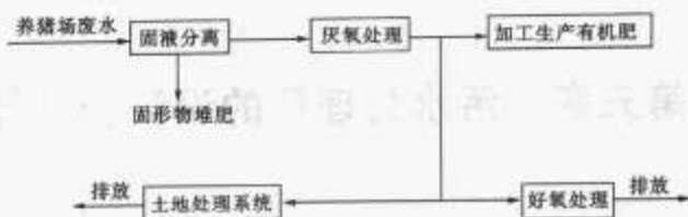
图 4-16 规模化养猪场废水处理工艺流程
